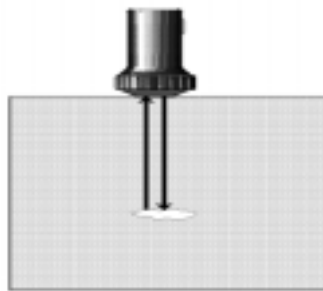
图 1.1 超声探伤基本工作原理
